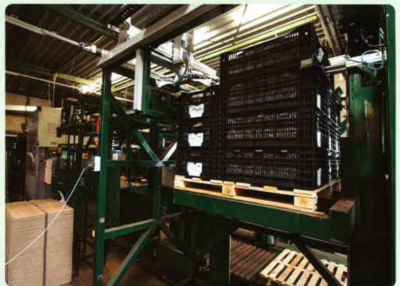
VWS beschikt over een volautomatische inpaklijn. Gemiddeld worden hier zo'n 300 kisten per uur exportklaar gemaakt.
